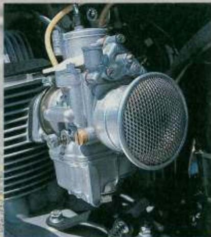
Leistungssteigernd: 36er Dell'Ortos versorgen den dank Alfa-Kolben höher verdichteten Motor über optimierte Kanäle mit zündfähigem Gemisch
